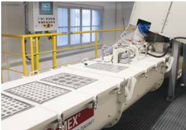
Mit der neuen Anlage wird der Asbest in einem Betonblock eingebunden und kann so sauber und rückholbar in Deponien verbaut werden
