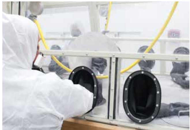
Der Zugang zum Material erfolgt ausschließlich mit persönlicher Schutzausrüstung und über Handschuh-eingriffe
